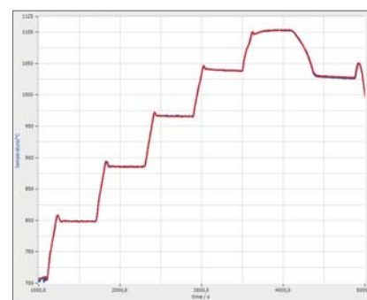
图2: 两台发射率修正高温计通过两个视孔在G3行星式反应器检测的裸硅晶圆温度。1号视口：经由AbsoluT 950校准的EpiTT Gen3在950 nm条件下的ECP传感结果(红色)。2号视口：经由AbsoluT 400校准的Pyro 400 Gen3在410 nm条件下的ECP传感结果(蓝色)。
